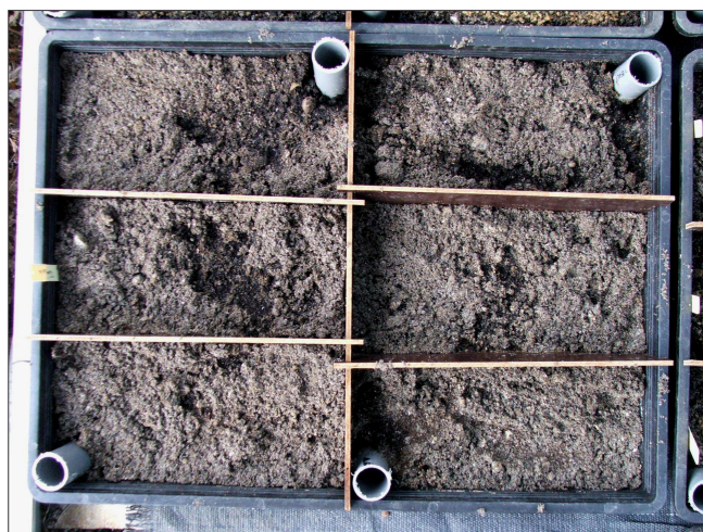
Figure 12: Bacs de culture destiné à recevoir 6 échantillons de sol. Les différents espaces sont séparés par des panneaux marins, et 4 tuyaux qui serviront à l'arrosage sont placés dans les coins.
